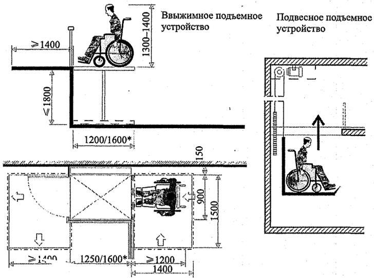
Габариты при установке домашнего лифта и подъемника
