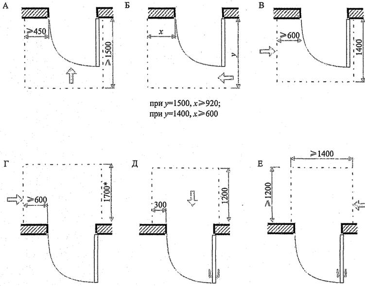
А, Б, Г – двери без запора; В – дверь с закрывателем; Д, Е – двери имеют ручку и закрыватель
