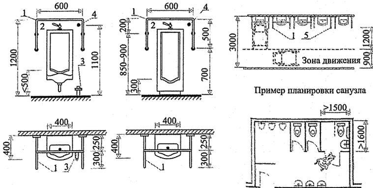
1 – поручни опоры; 2 – смывной кран (ручной); 3 – смывной кран (ножной);
