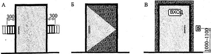
А – изменение фактуры и цвета полосы ориентации перед дверным проемом; Б – указание направления открывания дверей; В – выделение контрастной фактурной полосой дверного проема
