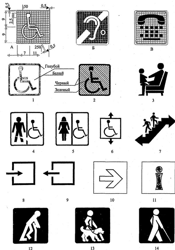
А – пропорции символа доступности для инвалидов; Б – пропорции символа доступности для инвалидов по слуху; В – пропорции символа «Телекоммуникационные устройства для людей с нарушением слуха»
