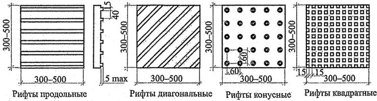
Тактильно-визуальные покрытия с использованием полимерных покрытий
