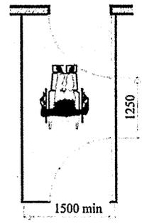
Складывание дверей при аварийной ситуации
