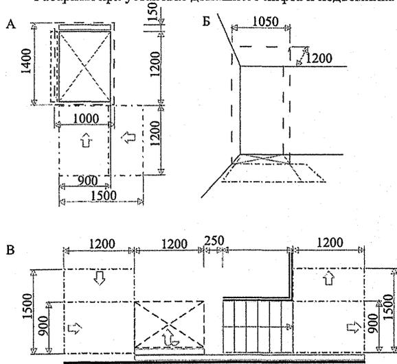
А – вертикальный подъемник; Б – лифт; В – наклонный подъемник (откидная платформа)
