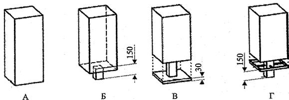
А – элемент доходит до пола; Б – низ элемента возвышается над полом не более 150 мм;
