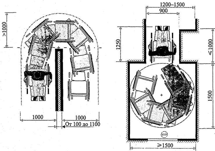
Рисунок В.9 – Габариты поворотов и разворотов кресла-коляски
