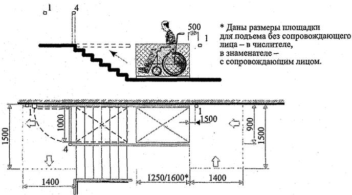
Рисунок В.25 – Параметры наклонных подъемников
