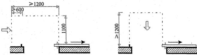
Рисунок В.13 – Габариты придверных зон
