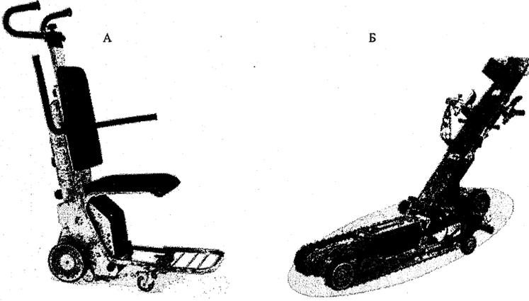
А – колесный подъемник; Б – гусеничный подъемник
