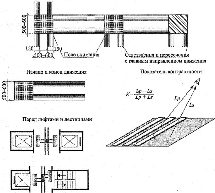
$L_s$  – яркость горизонтальной поверхности (канделы/кв.м);
