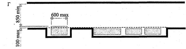
А, Б – сохранение пропускной способности коридоров; В – безопасное размещение смонтированных на стене объектов; Г – заглубление объектов в нишу
