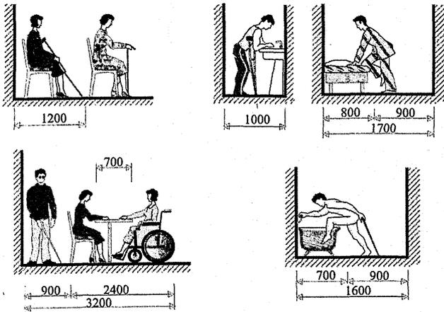
Рисунок Г.5 – Параметры функциональных зон
